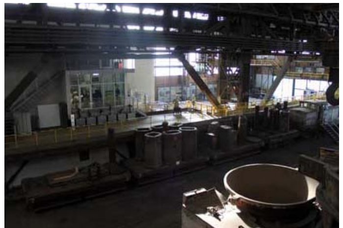
Abb. 10 Kukillenwagen an der Gießerbühne
