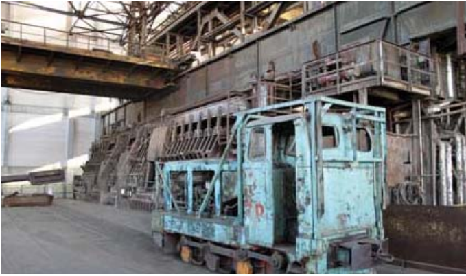
Abb.7 Die Ofenbühne nach Osten mit Bühnenlok, links hinten: Ausleger eines Chargierkrans mit eingehängter Schrottboxe
